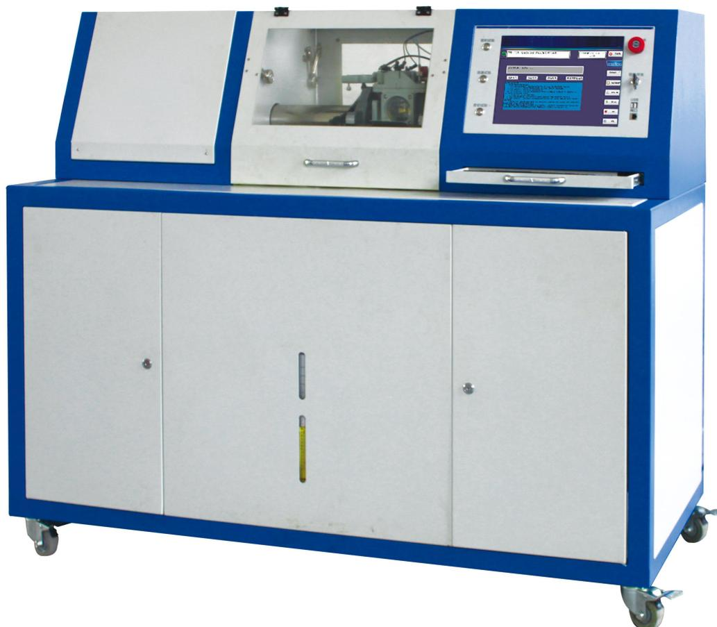
ZX-RLT 瓦斯继电器校验台是一种全新设计的气体继电器的校验和检测设备。该校验台模拟变压器内部故障时气体继电器动作机理，采用新一代嵌入式控制和高精度传感器测量技术，准确检测瓦斯继电器动作流速值和动作气体容积值，测试速度快，准确性高，试验重复性好。采用液压传动压紧机构，安置瓦斯继电器操作轻松省力，自动化程度高。
